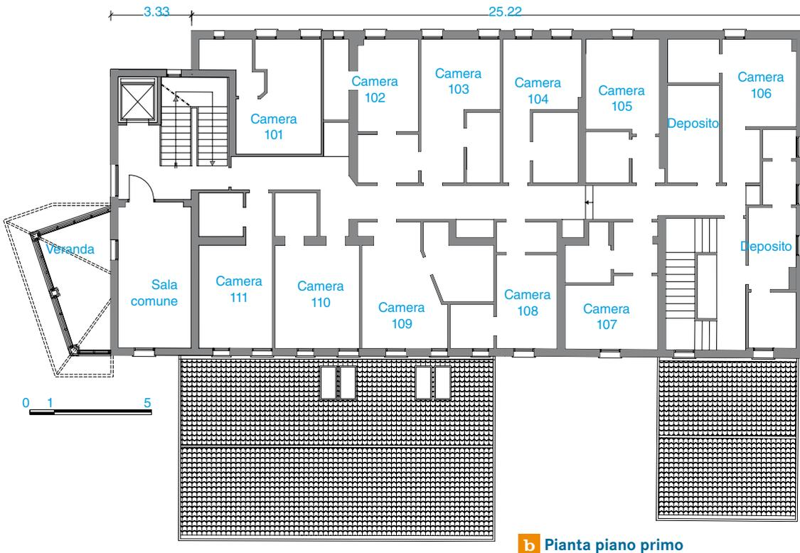
**8** ► Progetto definitivo con identificazione della struttura finale: (a) pianta piano terra con reception albergo, ristorante e relativi locali, alloggio privato direzionale; (b) pianta primo piano con suddivisione degli alloggi per la clientela
