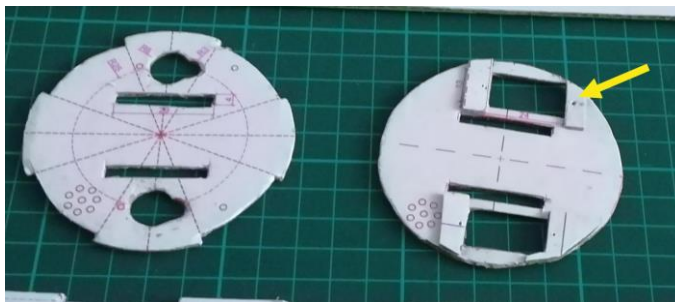
Fig. 25 Base di fissaggio dei motori
