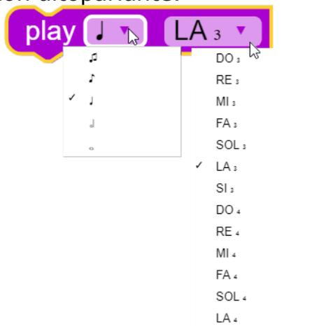
Il blocco **PLAY** permette di inserire una nota controllando sia la sua durata che l'altezza. L'altezza delle note si realizza in due ottave.
