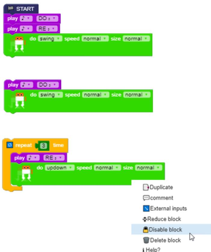
Cliccando il tasto destro del mouse sopra un blocco, si apre una finestra di selezione con alcune funzioni di scelta, come *Duplicate* o *Disable block* per disattivare le istruzioni di un blocco senza cancellarlo.
